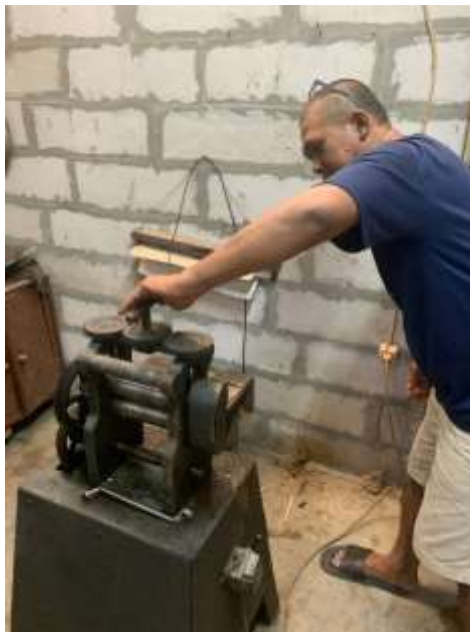
Gambar 4. Bpk. Sarijo masih menggunakan mesin sederhana untuk proses menipiskan perak
